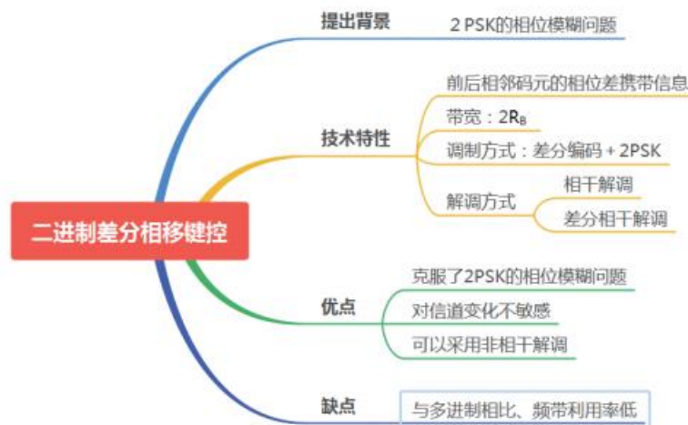
图 3 二进制差分相移键控技术的思维导图
